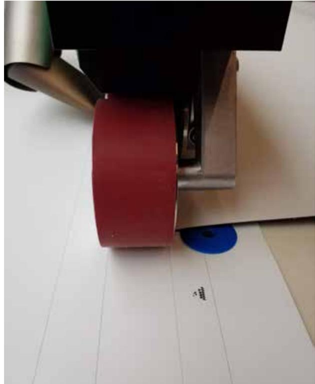
Líneas de solape de la lámina de TPO marcadas por el fabricante
