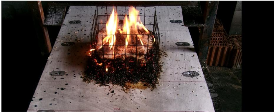
Fotografía 35. Ensayo con antorcha ardiendo (imagen facilitada por AFITI).
