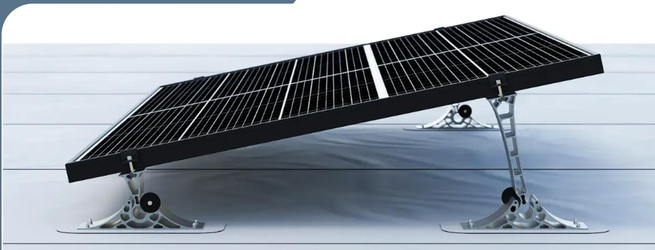
**DESCRIPCIÓN:** Soporte solar de aluminio (AL 6063 T6) para la fijación de paneles solares a cubiertas planas impermeabilizadas con TPO. Permite la colocación de los paneles sobre soportes específicos soldados por termofusión sobre la lámina de impermeabilización de TPO, sin perforaciones adicionales de la lámina de la cubierta.
