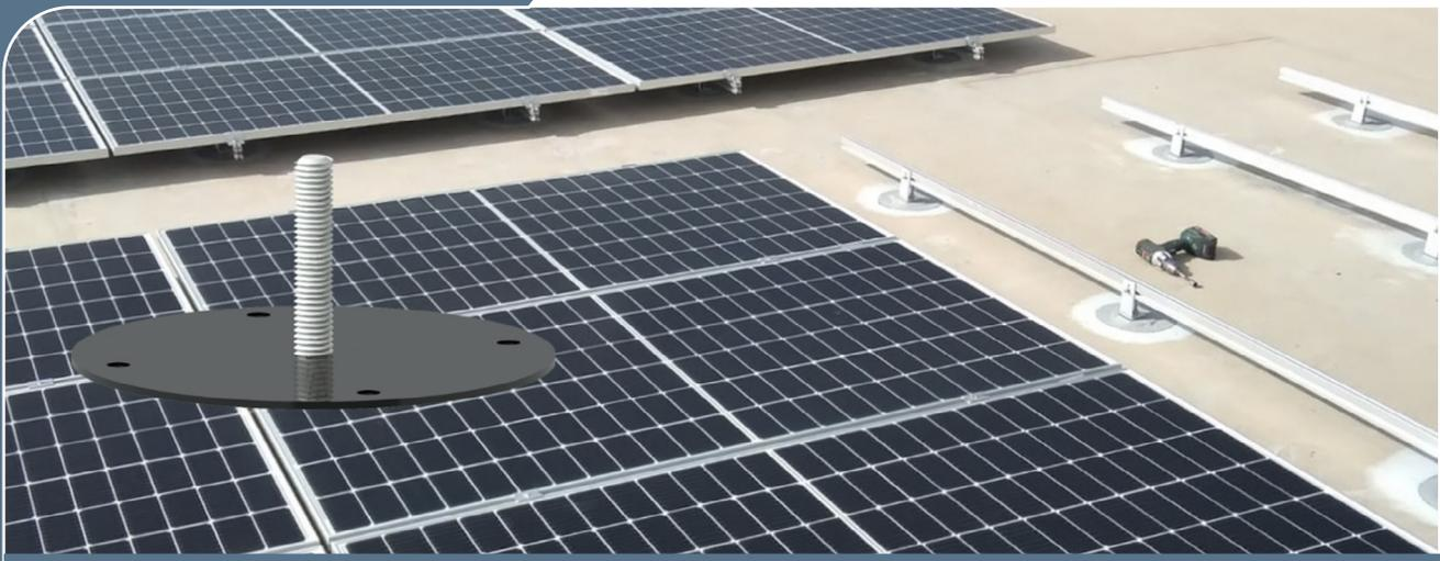
**DESCRIPCIÓN:** Sistema de fijación mecánica para cubiertas solares formado por una base metálica soldable con la membrana de impermeabilización que se une mediante fijaciones mecánicas al soporte de la cubierta permitiendo resistir elevadas cargas de succión de viento sin añadir sobrepeso a la cubierta. Las piezas se impermeabilizan posteriormente con una pieza de remate del mismo material de la membrana de la cubierta quedando totalmente estancas.
