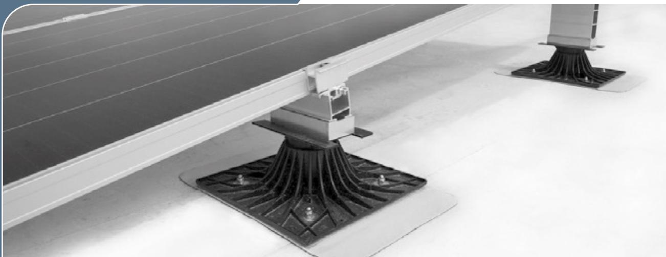
**DESCRIPCIÓN:** Soporte ajustable en altura de poliamida para paneles solares diseñado para cubiertas planas, para su aplicación directa sobre la impermeabilización evitando perforarla. El soporte lleva fijado un trozo de impermeabilización que permite adherirse por termofusión sobre la impermeabilización de la cubierta, y se completa con alzadores y bridas de aluminio para la fijación del panel.
